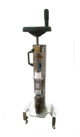
Lo strumento tipo torchio qui raffigurato consente la spremitura ed il filtraggio dell'olio di cannabis. La spremitura avviene in una siringa sterile (da 100 ml) facilmente removibile attraverso uno sgancio ad attacco rapido, all'interno della siringa viene inserito un filtro specifico in acciaio inox opportunamente riutilizzabile.
